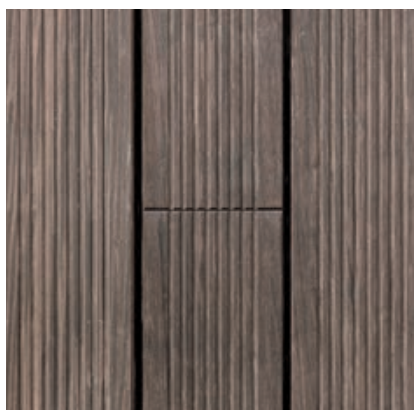
Abstufung der Vergrauung von Bamboo X-treme im Laufe der Zeit: neue, nicht verwitterte Terrassendielen (links), 3 Monate der Witterung ausgesetzt (Mitte) und 18 Monate der Witterung ausgesetzt (rechts).
